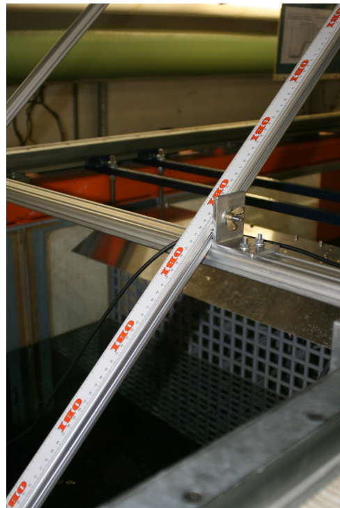
Abbildung 14: Profilschienen zur Einstellung der Sperrenneigung mit Skala und Feststellschraube
