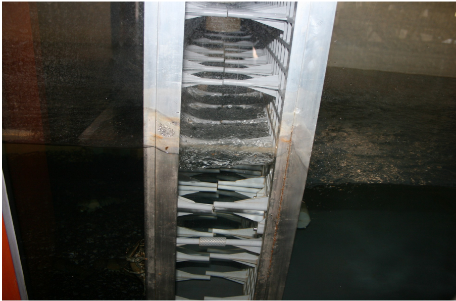
Abbildung 18: Stauwirkung am 18 cm breiten Zwischenstück zwischen Sperre 1 (links) und 2 (rechts)
