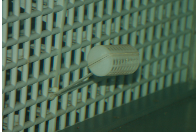
Abbildung 11: Köderkörbchen am oberhalb der Sperre gelegenen Gitter
